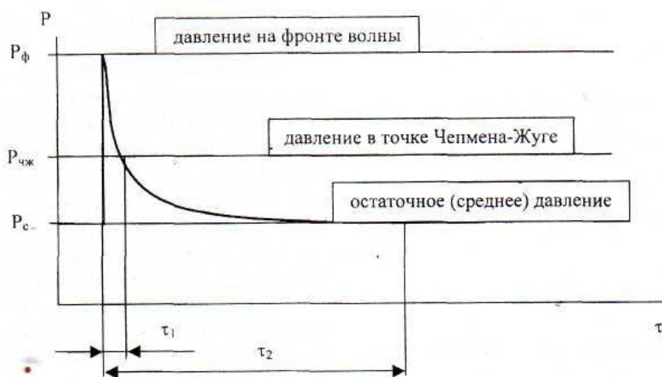
Рис. 3. Характер изменения давления в волне детонации
