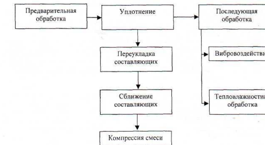
Рис. 5. Этапы комплексной обработки бетонной смеси на базе взрывных импульсов
